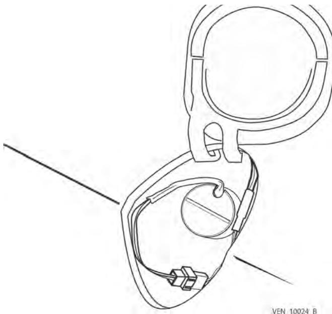
**Figura 7-5. Ubicación del sensor de O<sub>2</sub>**
